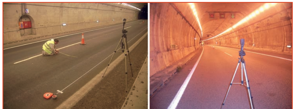
[Figura 5] .- Instantáneas del proceso de medición de luminancia.
