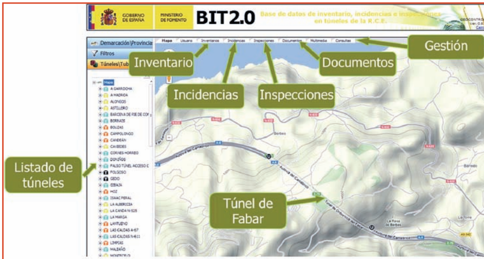
[Figura 9].- Vista de la aplicación informática BIT 2.0 para gestión de la información de los túneles de la R.C.E.
