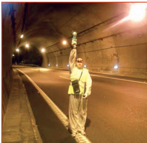
[Fig. 3] .- Realización de una medición de velocidad de aire en la sección transversal de un túnel.
